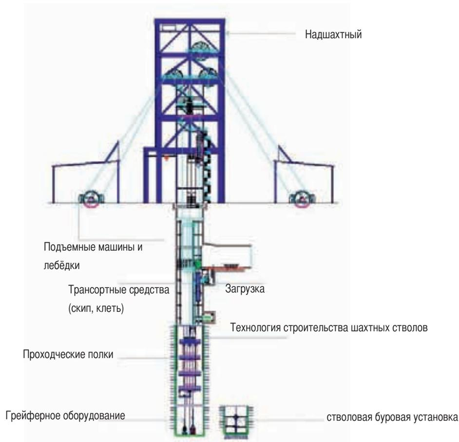
Современные технологии шахтостроения – техника для шахтостроения и подъемно-транспортная техника из одних рук!
