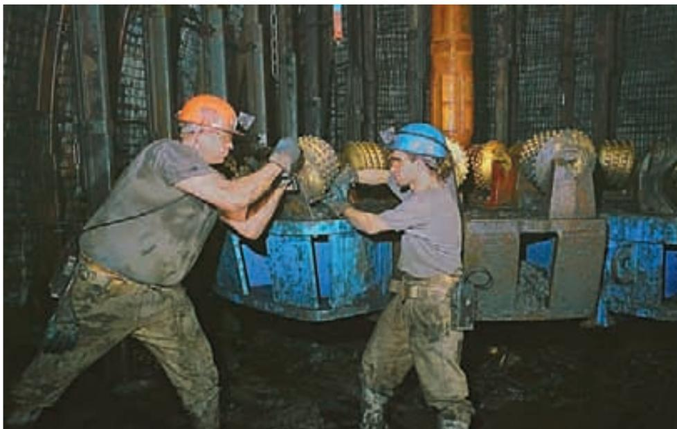
Монтаж буровой головки у основания слепого шахтного ствола
