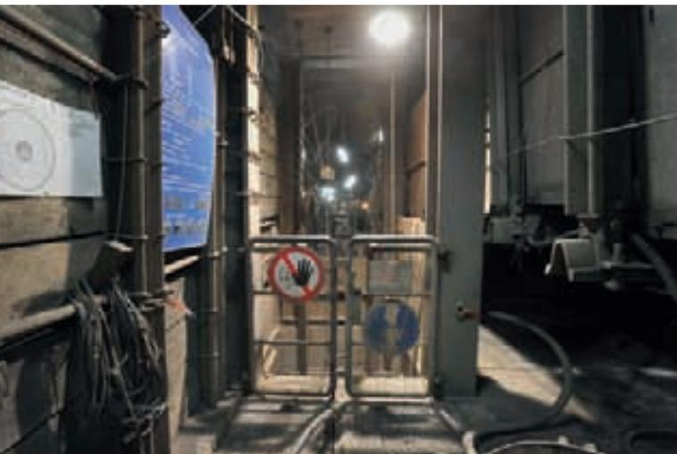
Доступ к углубленному входу в клеть для осмотра бункера, справа, ленточный конвейер со стальной обшивкой для защиты от взрывов
