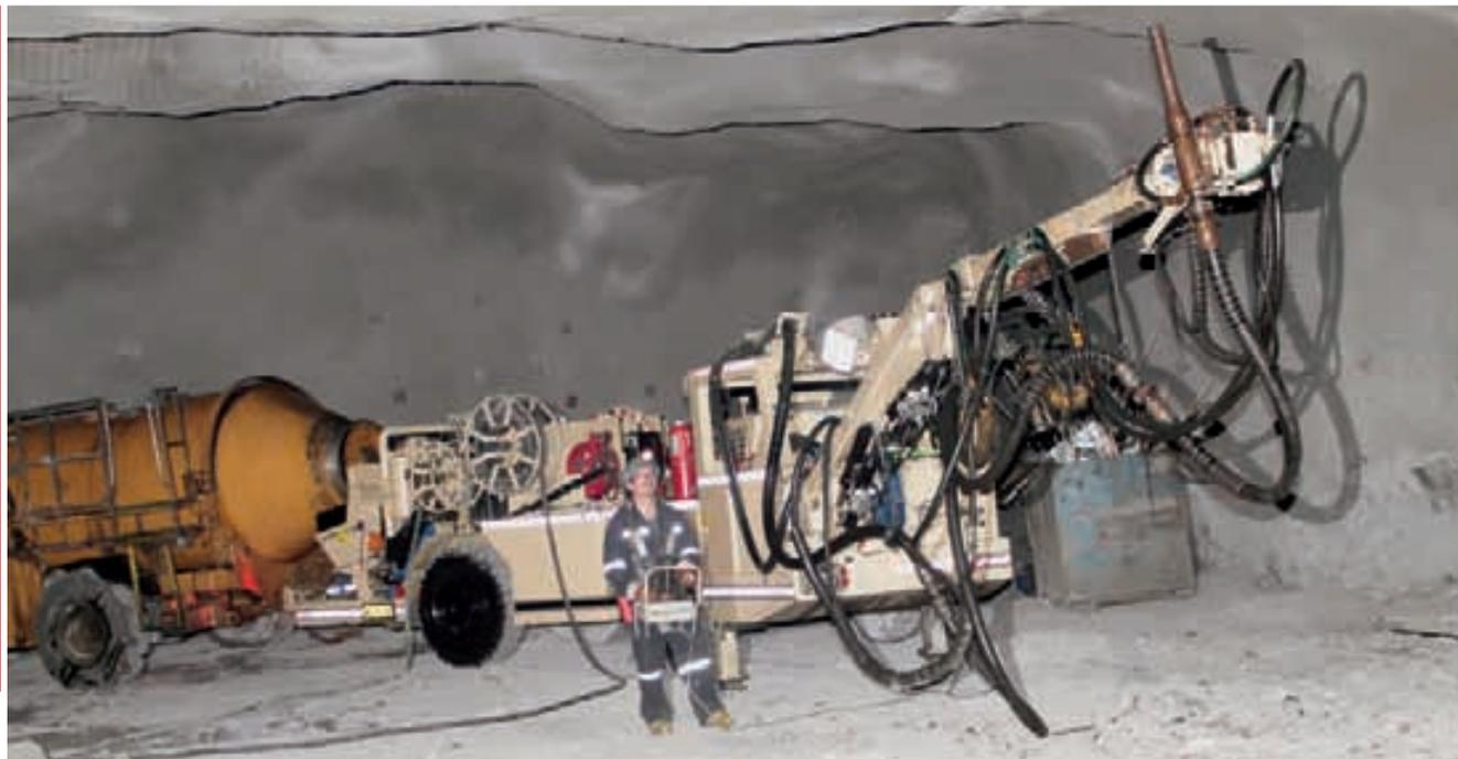
Установка для нанесения набрызгбетона с силосом
