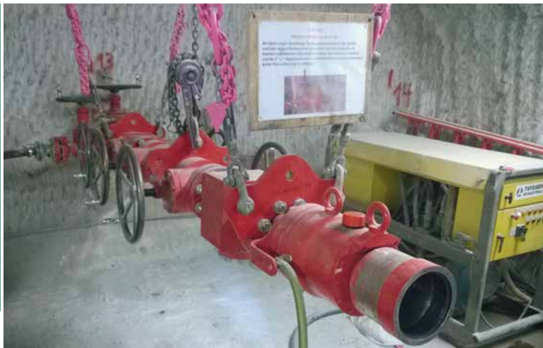
Комплект противовыбросовых превенторов для безопасной работы
