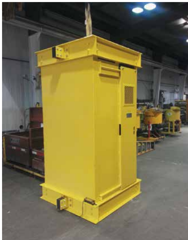
После успешно проведенного испытания на вертикальность новая клетка готова к загрузке
