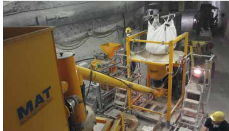
Станция разгрузки мягких контейнеров (биг-бэг упаковок)
