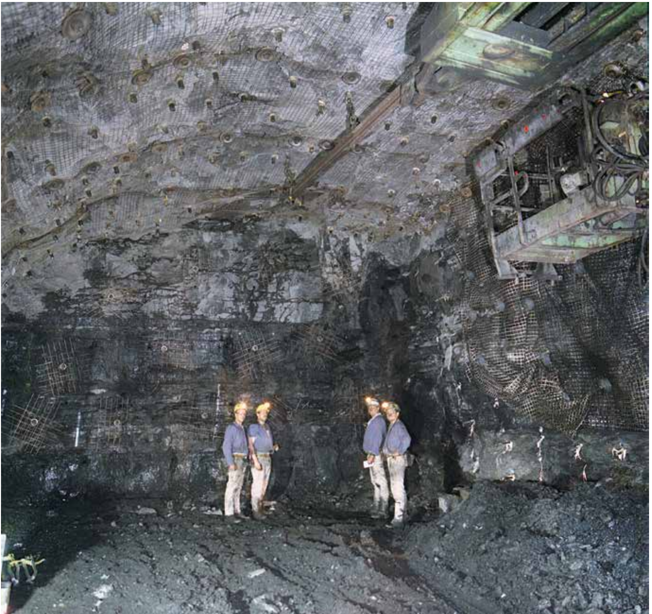
Постоянная крепь, возведенная вокруг целика
