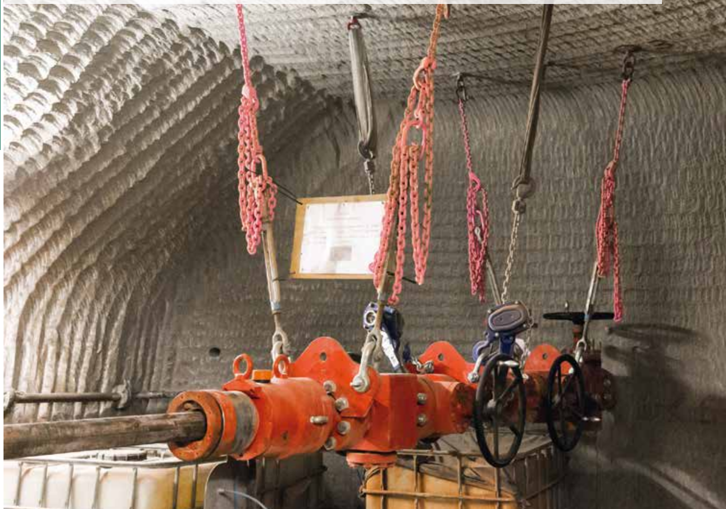
Противовыбросовые превенторы для разведочного бурения под землей для определения места сопряжения в стволе Асссе5
