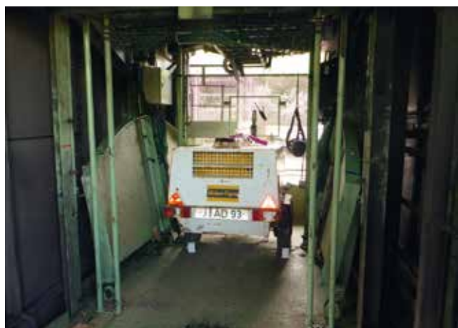
Рабочий полк с компрессором на нулевой отметке
