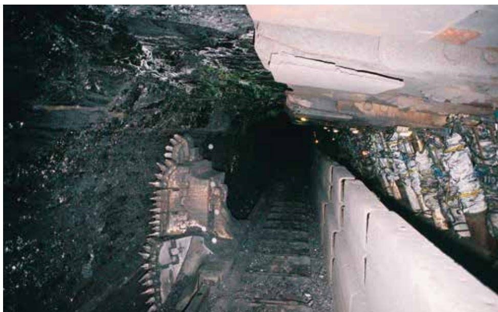
Разработка длинными очистными забоями-струговая лава
