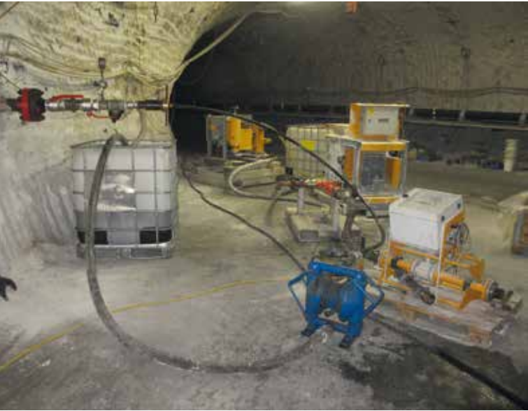
Оборудование для ликвидации шпуров
