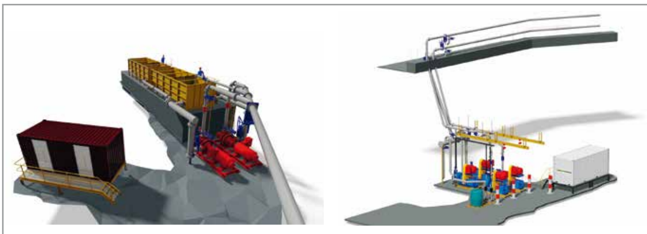
Схематическое изображение отдельных частей установки для отвода шахтных вод
