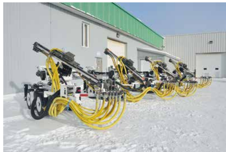
Пневматическая установка для бурения глубоких скважин
