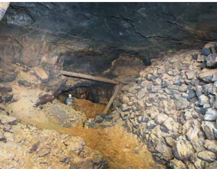
Расположенное вблизи от дневной поверхности место добычи скарна, с частичной закладкой пустой породой
