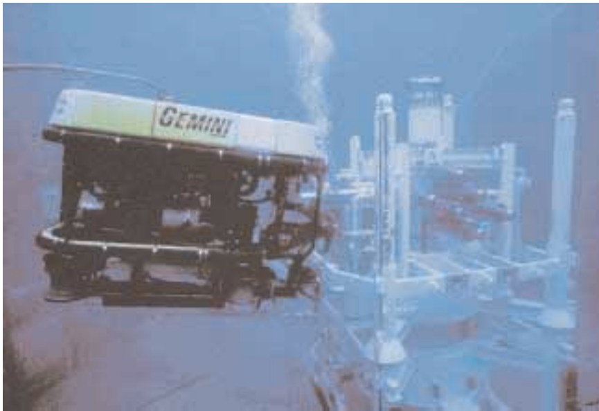
Rov beim Positionieren des Eruptionskreuzes auf dem Meeresboden
