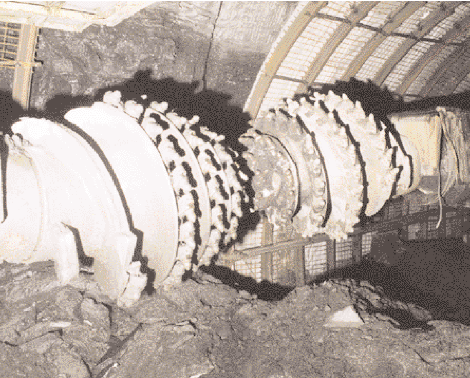
Durchschlägige Strecke mit Teilschnittmaschinen
