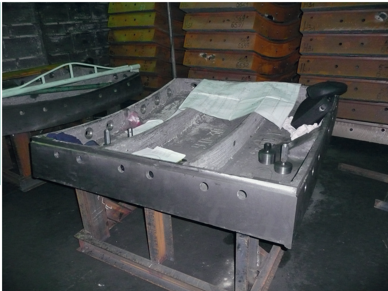
Осмотр тьюбингов и контроль качества на заводе-производителе в Украине
