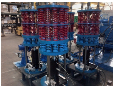
Новые пружинные приводы для барабанных тормозов производства фирмы Siemens в стадии тестирования с новым гидравлическим агрегатом
