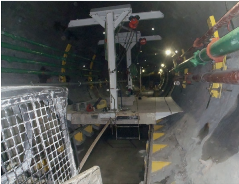
Тележка для подвозки труб и монтажа оборудования в откаточной выработке
