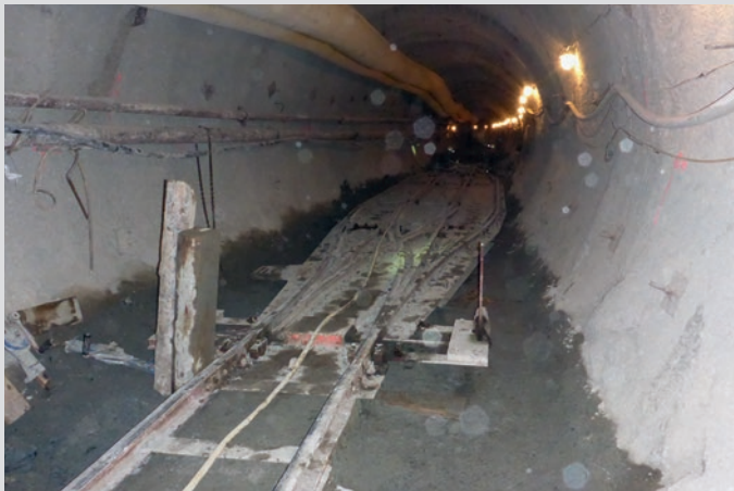
Трехпутевая стрелка в выработке с сечением 15 м 2
