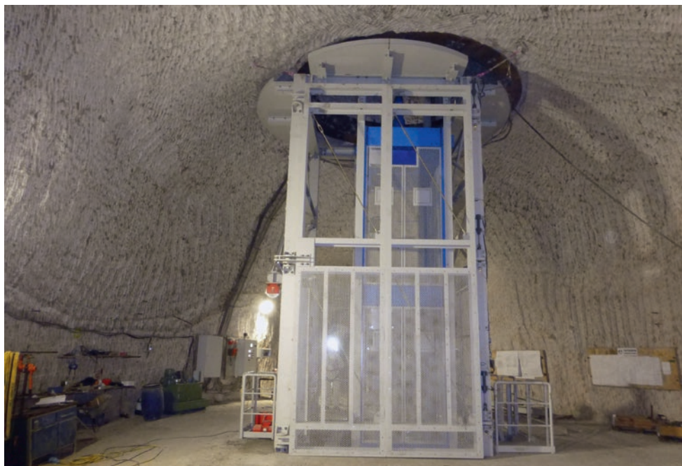
Рудничный станок на отм. 750 м, вид на ворота для крупных деталей с юго-западной стороны
