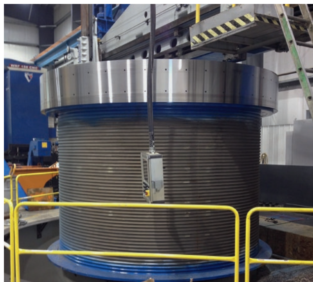
Механическая обработка тормозной поверхности на барабане
