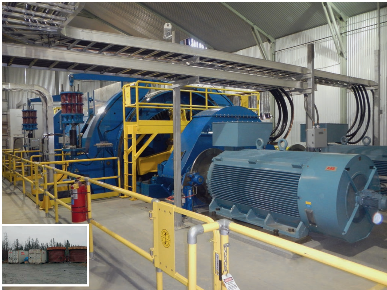
Проходческая подъемная машина фирмы Nordberg перед ее приобретением Проходческая подъемная машина фирмы Nordberg после монтажа и ввода в эксплуатацию с лестницами, помостами и новыми моторами переменного тока.
