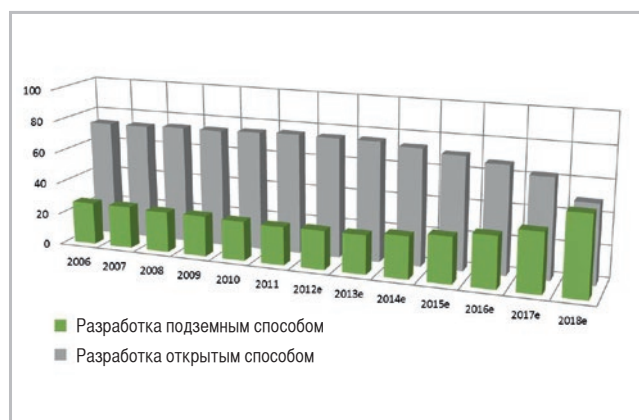
Рис. 1. Динамика изменения способов разработки месторождений (Rio Tinto, 2011)
