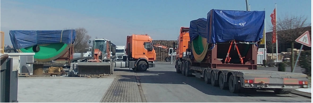
Зрительное сравнение размеров – Половинка барабана помещается на 25-тонном грузовом автомобиле
