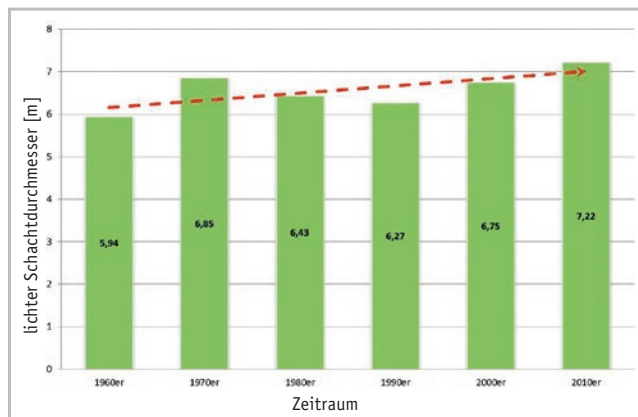
Abbildung 4: Lichte Schachtdurchmesser im Durchschnitt
