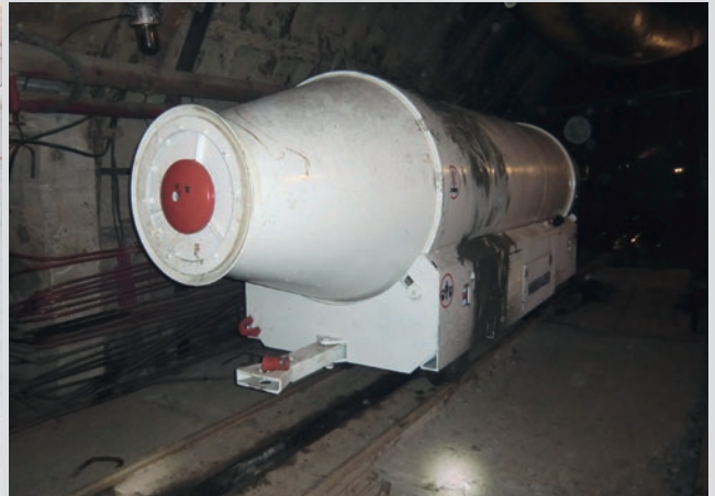
Der erste Betonnachmischer unter Tage am 15. August 2013
