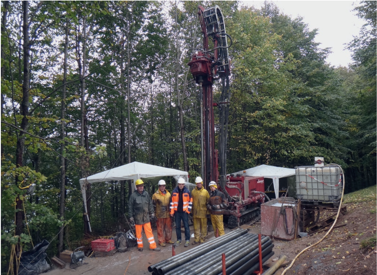
Bohrplatz für eine 300 m tiefe Explorationsbohrung in abwegigem Gelände
