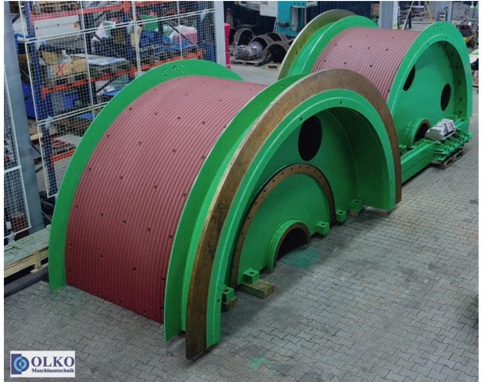
Fertig vorbereitet zum Verladen: Seiltrommelhälften
