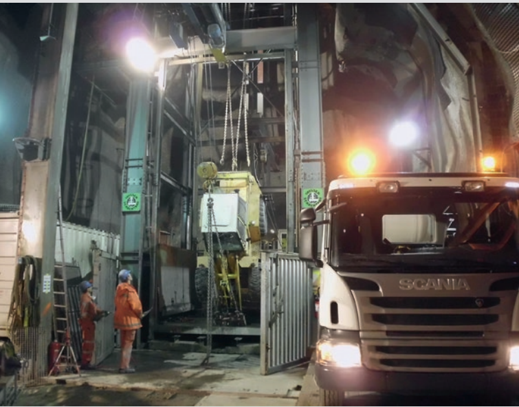
Abb. links: Schwerlasttransport: Einhängen am Schachtkopf Abb. oben: Entladung von überlangen Plattenwagen am Schachtfuß
