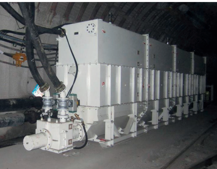
Zwischen- bzw. Endbunker als Baukasten-System
