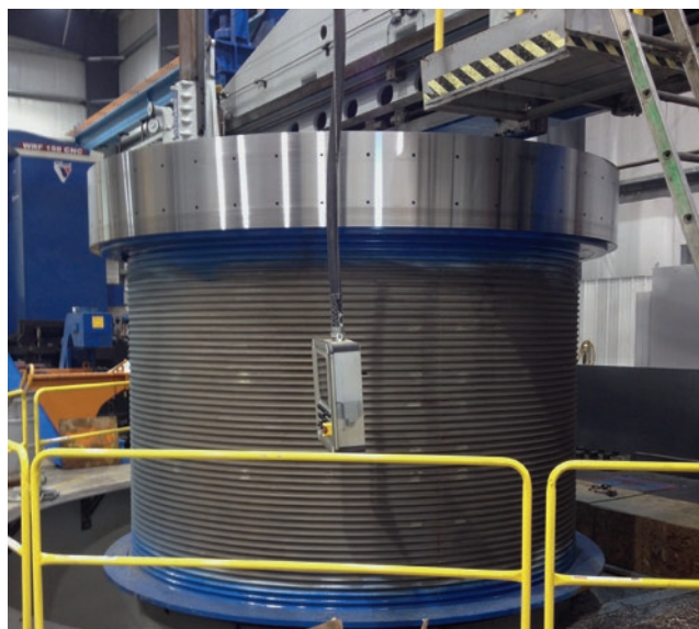
Maschinelle Bearbeitung der Bremsfläche auf der Trommel
