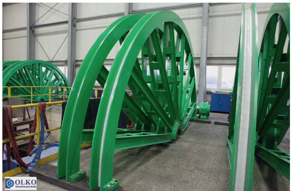
Fertig vorbereitet zum Verladen: Seilscheiben
