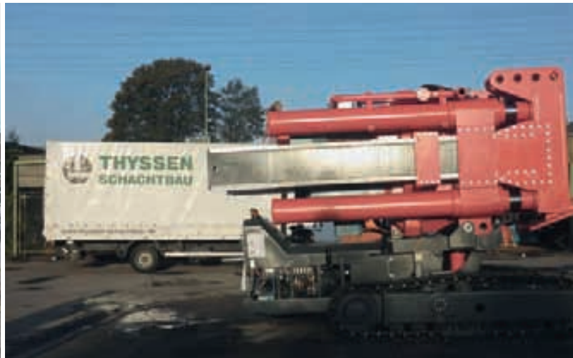
Raisebohrmaschine Rhino 2007 auf Raupenfahrwerk
