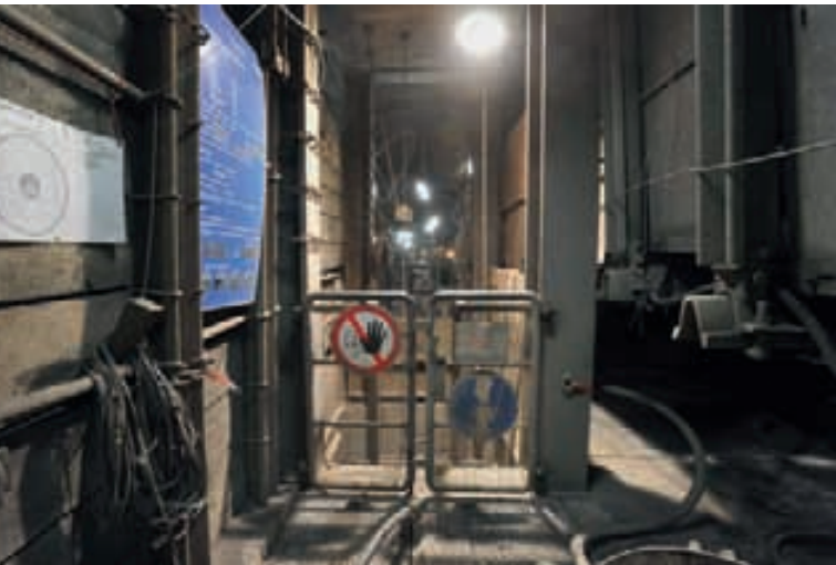
Eingang zum tiefergesetzten Korbaufstieg für die Bunkerbefahrung, rechts Bandstraße mit Stahlverkleidung für den Sprengschutz
