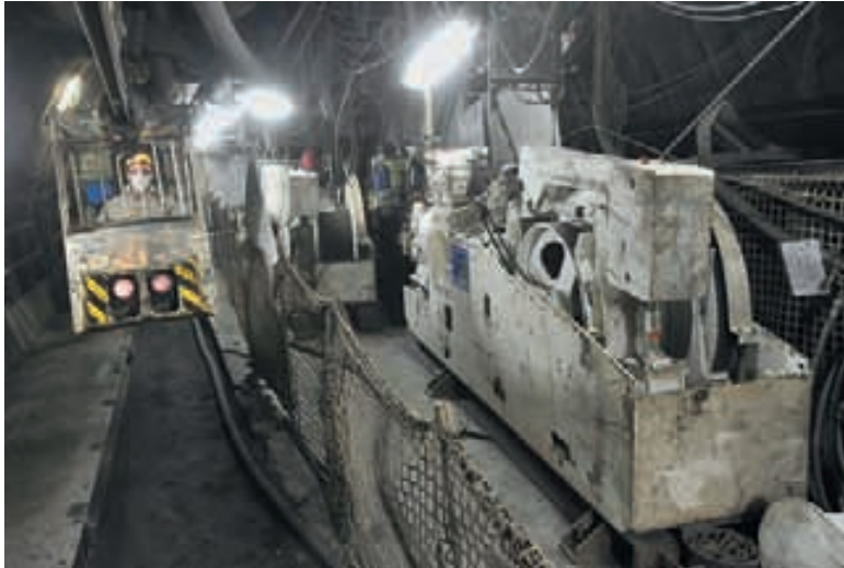
Teufwinden und laufender Dieselkatzenbetrieb
