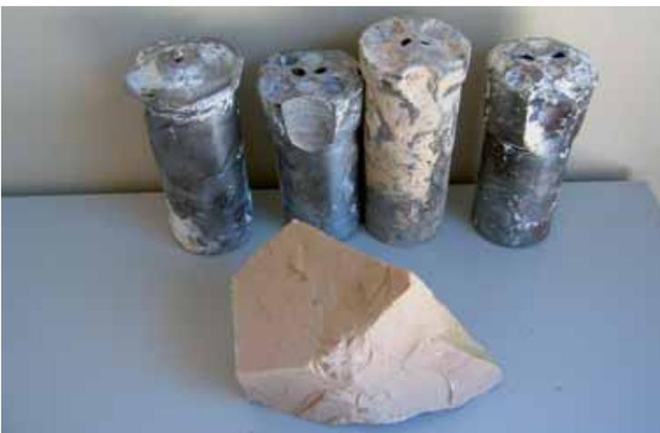
Marmorisierter Kalk und seine Folgen für das Bohrwerkzeug
