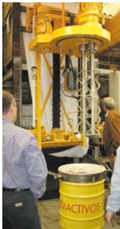
Konditionierungsanlage: Inaktiver Probelauf
