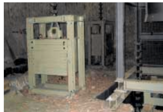
Führungsseilspanngewicht mit Führungsrahmen an der 840 m Sohle
