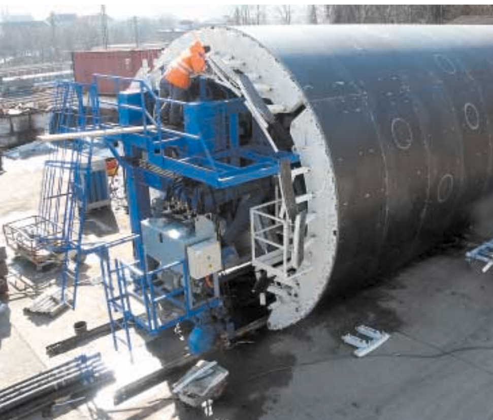
Komplettansicht des vormontierten Tunnelschalwagens
