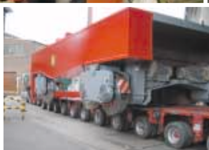
Stahltransportwagen 11 x 6 x 7,3 m; Tragkraft 420 t
