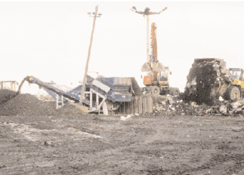
2. Arbeitsschritt: Grobseparierung des Deponiegutes
