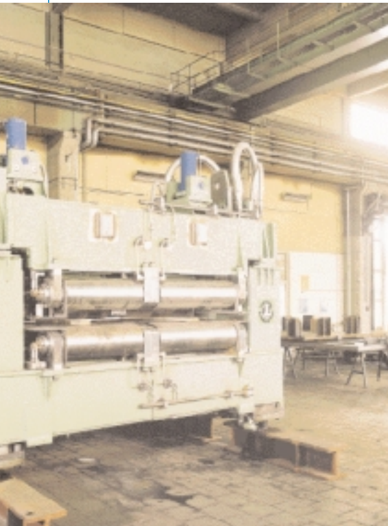
Das Stranggußsegment bei der Vormontage in der Maschinentchnik
