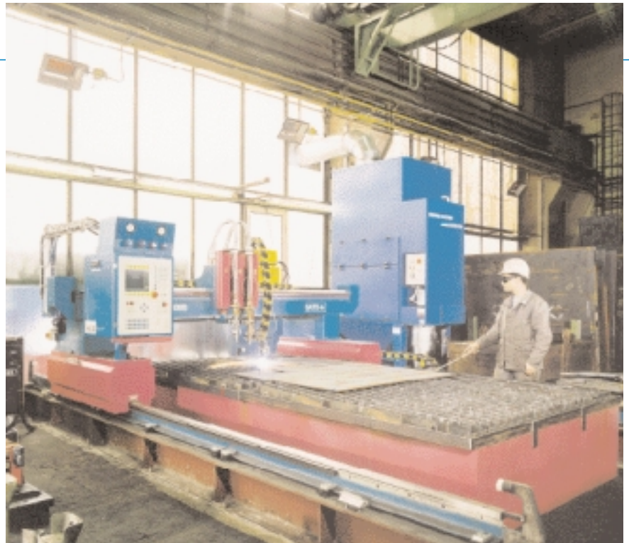
CNC-Brennschneidmaschine in der Maschinentchnik Nur mit moderner Technik ließen sich die geforderten Toleranzen verwirklichen
