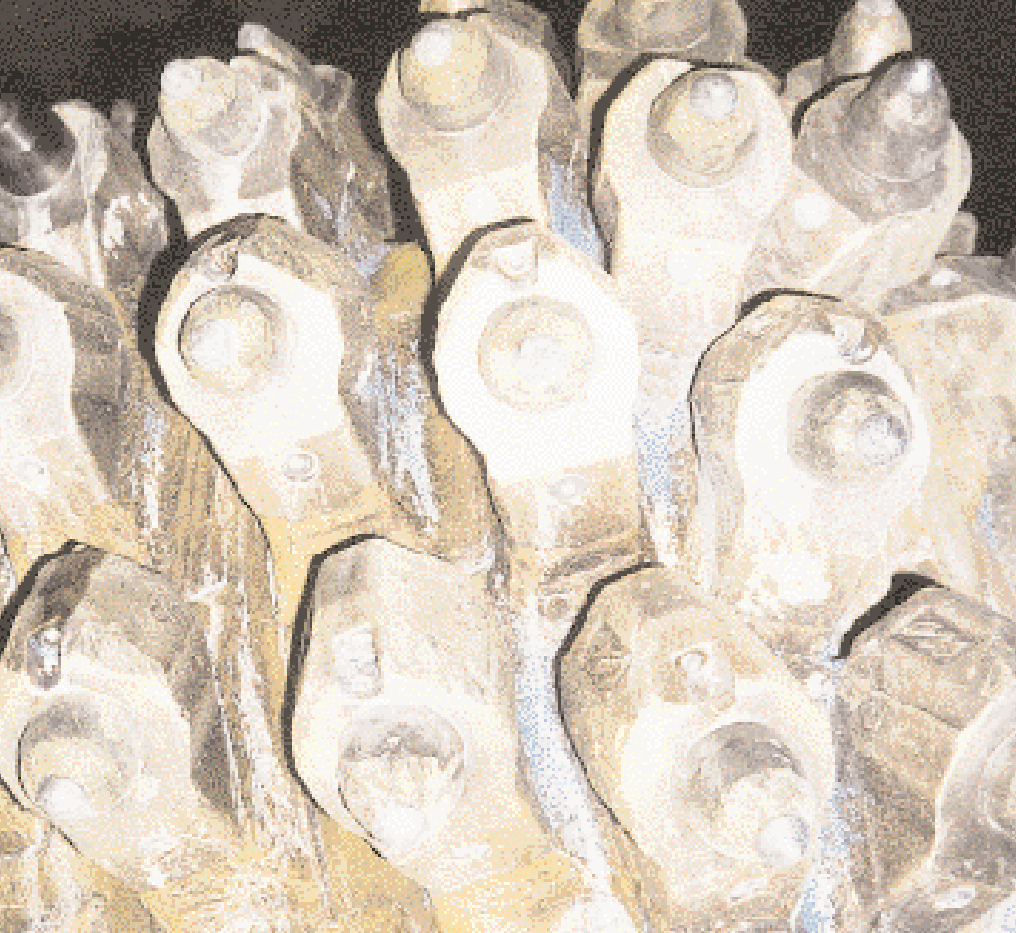
Neue Meißel – neue Meißelhalter – neues Schneidkopfdesign, abgestimmt auf spezifische Gesteinseigenschaften
