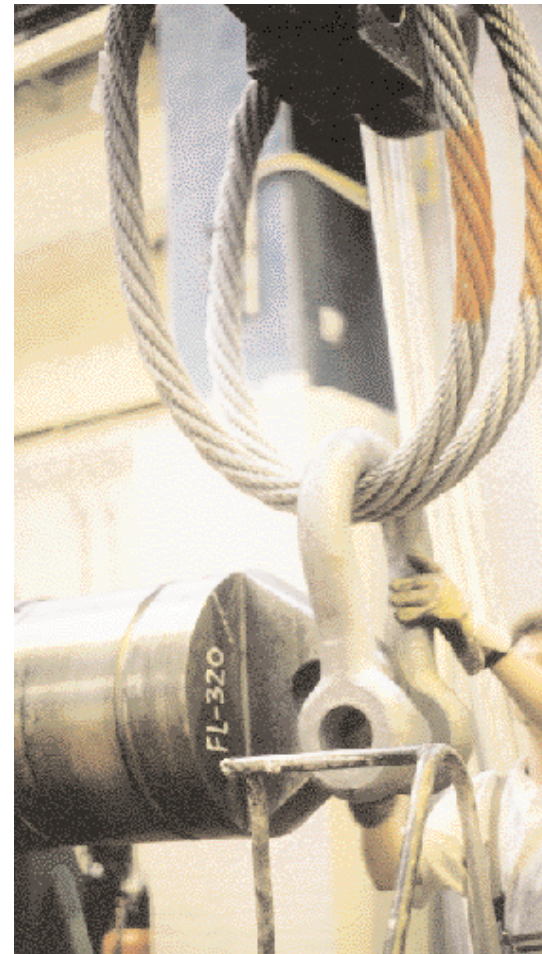
Abb. 2: Wendemutter mit Anschlagmittel
