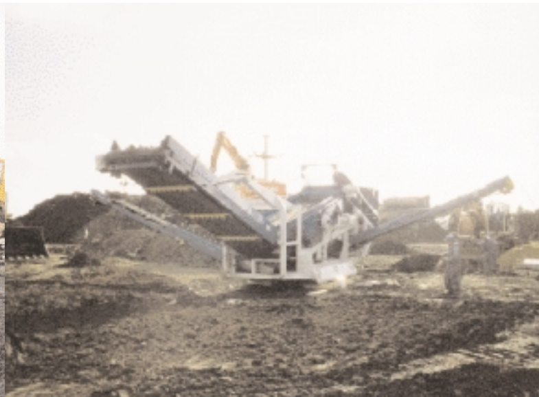
3. Arbeitsschritt: Siebung zur Trennung von Fein- und Grobgut
