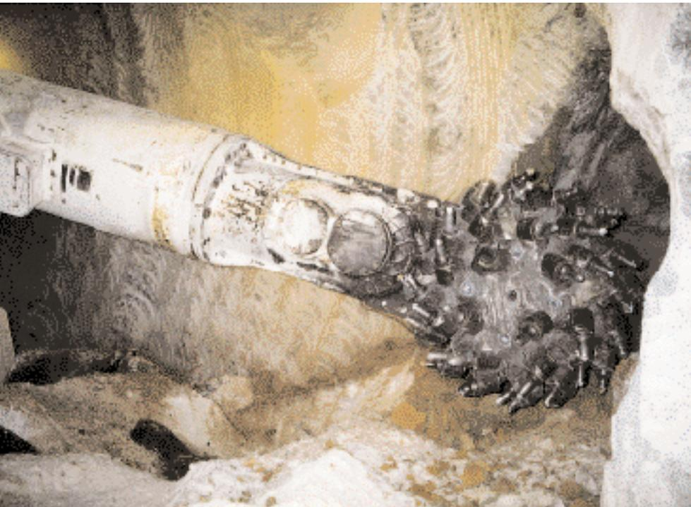
AM 50-Einsatz im Streckenvortrieb, Pfeilerdurchörterung
