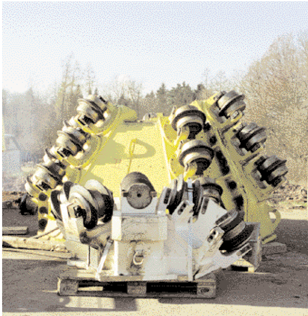
Bestücken des Bohrkopfes mit Diskenbohrwerkzeugen
