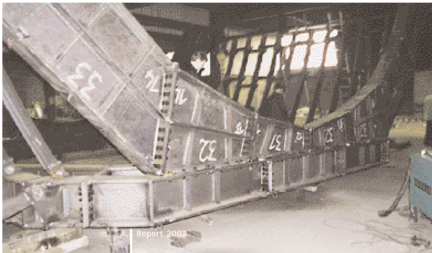
Kopfrahmen, Polygon, Schachtglockenbaue in der Fertigungswerkstatt
