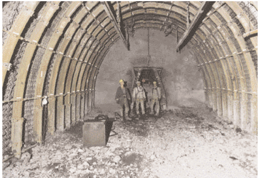
Durchstich zum Schacht im Türstockausbau
